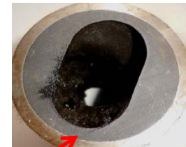
Endurecimiento del elastómero – dureza Shore A 90
