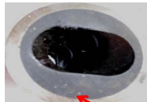
Endurecimiento del elastómero – dureza Shore A 90
