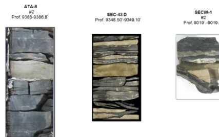
Decantación rápida en condiciones restringidas por variable salinidad, y/o turbidez.
