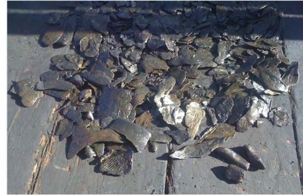
Estas fotos son algunos ejemplos de material de casing recuperado al intentar reparar pozos inyectores con alto grado de corrosión.
