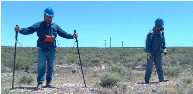
El DCVG es una técnica de medición indirecta que permite localizar fallas/daños en el revestimiento desde la superficie. El factor de %IxR (relativos) de cada indicación, determina su severidad
