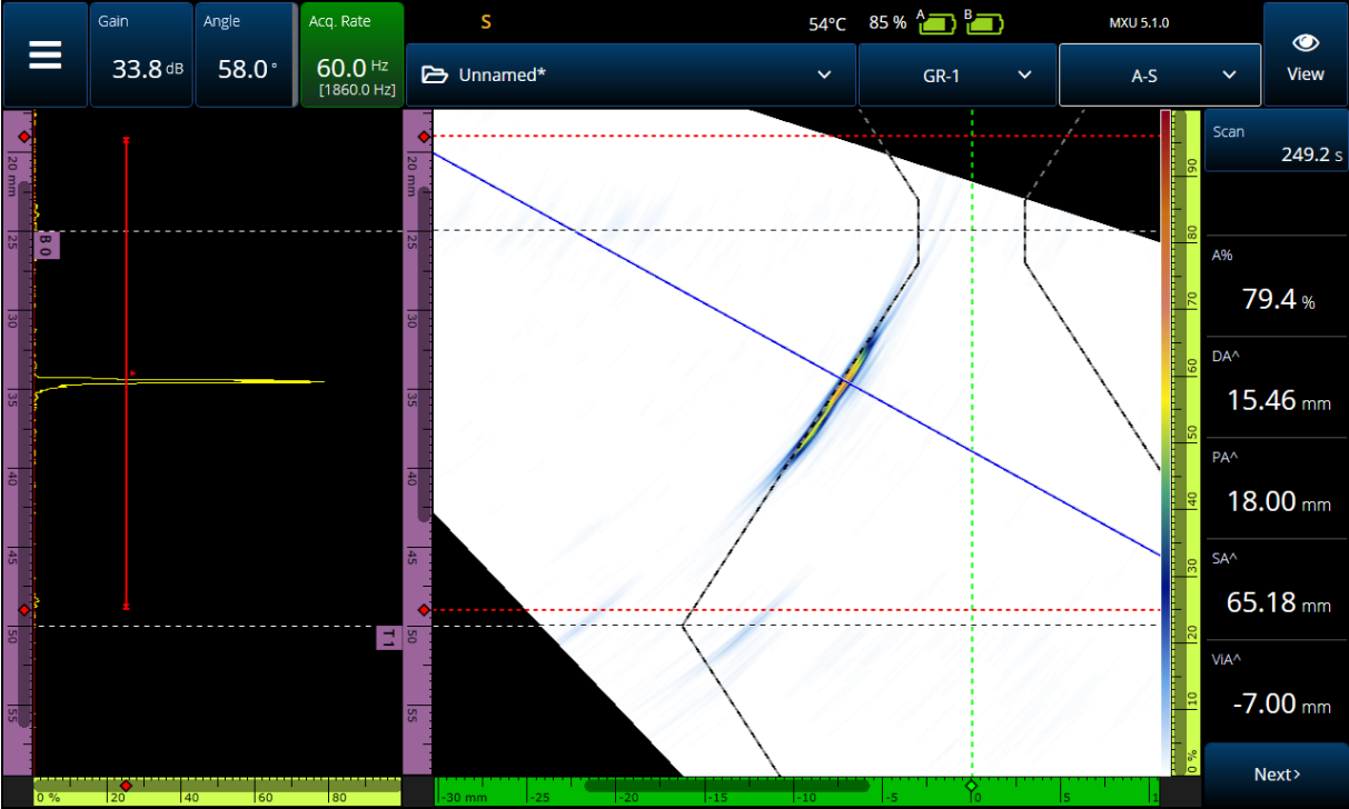
Falta de fusión lateral – Phased Array
