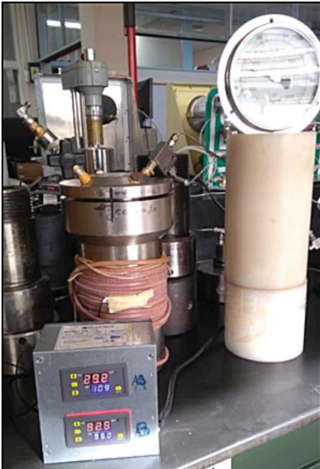
Figura 6. Celda empleada para la saturación con petróleo de los cuttingpacks .
