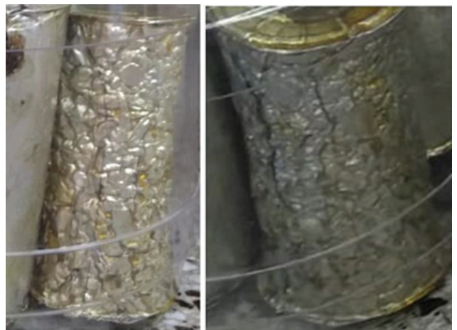
Figura 5. Cuttingpack armados con 100% de cutting en celda triaxial
