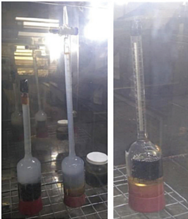
Figura 11. Ensayo de imbibición en copas Amott de los cuttingpacks, contactándolos con surfactantes y salmuera.
