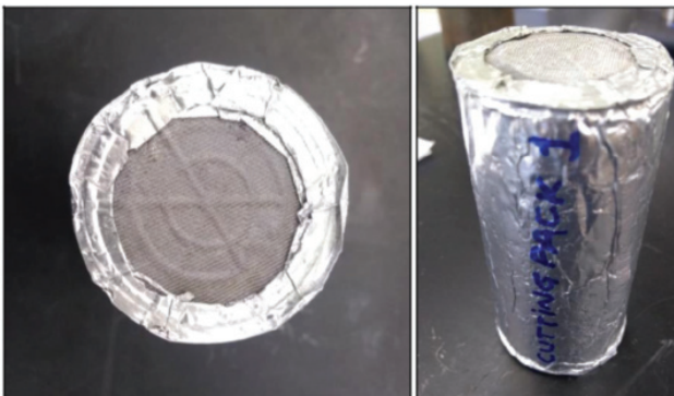
Figura 4. Cuttingpack armado con la celda triaxial.
