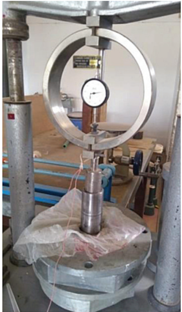
Figura 8. Prensa empleada para compactar los "cuttingpacks".
