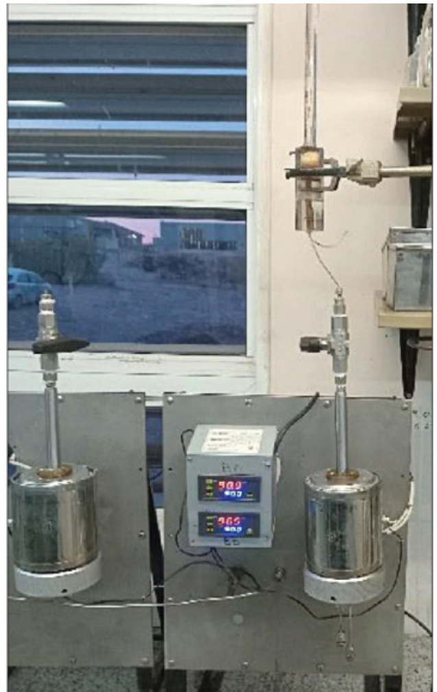
Figura 13. Ensayo de imbibición en plugs de corona preservada y resaturados, contactándolos con surfactantes y salmuera a presión y temperatura
