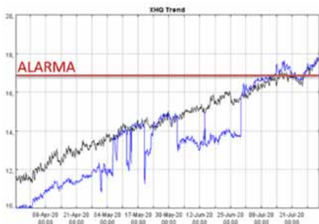
Figura 1. Desplazamiento axial turbina a vapor B-452.
