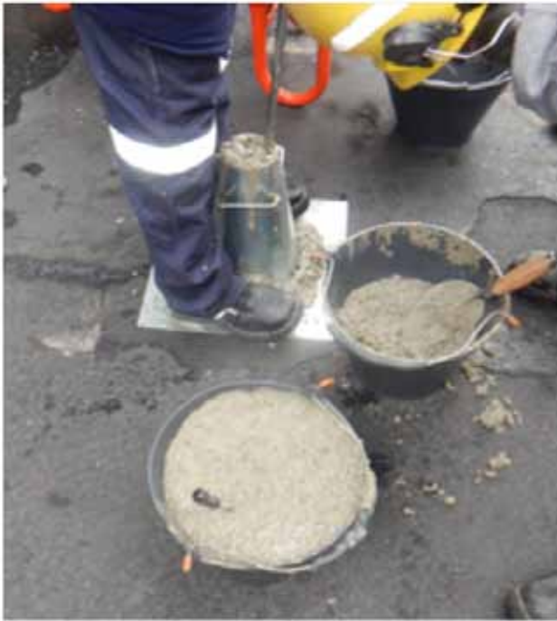
Figura 23. Fotografía de ejecución de probetas.
