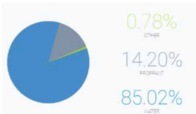
Figura 2. Composición de químico usado para fractura hidráulica. Fuente: Frac Focus (2023).
