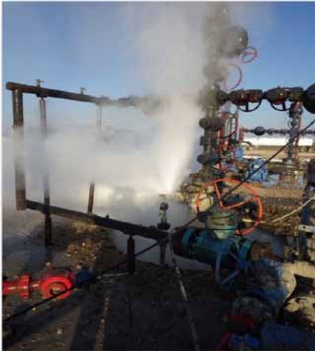
Figura 5. Imagen fuga de fluido en actividades de fracturamiento hidráulico. Fuente: Hartenergy (2023).
