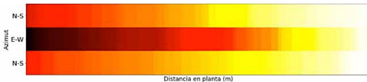
Figura 7. Matriz de probabilidad/intensidad de frac-hit en función de la distancia y azimut.
