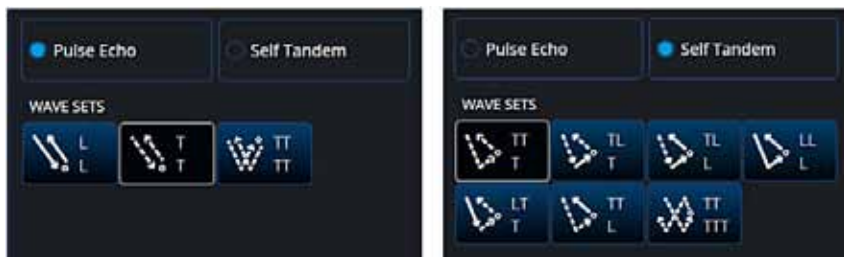
Figura 7b. Algunos modos de inspección, por pulso-eco y auto-tándem, en TFM.
