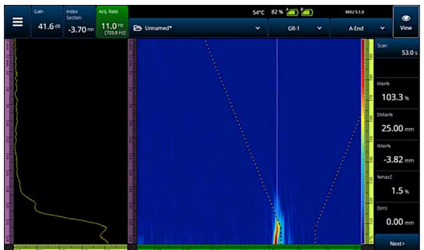
Figura 18. Fisura detectada por TFM (modo de onda 3T).
