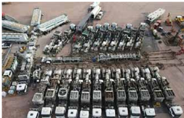
Figura 1. Set de fractura en pozo shale , actividad de fracking .
